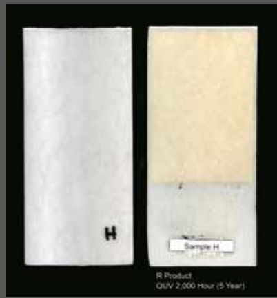
ภาพหลังการทดสอบ QUV Test ระยะเวลา 2,000 ชั่วโมง ของตัวอย่างแผ่นหลังคาผลิตภัณฑ์ R Product
