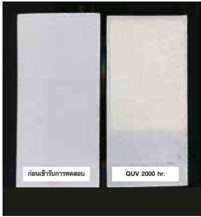
ภาพหลังการทดสอบ QUV Test ระยะเวลา 2,000 ชั่วโมง ของตัวอย่างแผ่นหลังคา RhinoGlass
