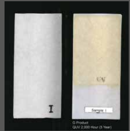
ภาพหลังการทดสอบ QUV Test ระยะเวลา 2,000 ชั่วโมง ของตัวอย่างแผ่นหลังคาผลิตภัณฑ์ G Product
